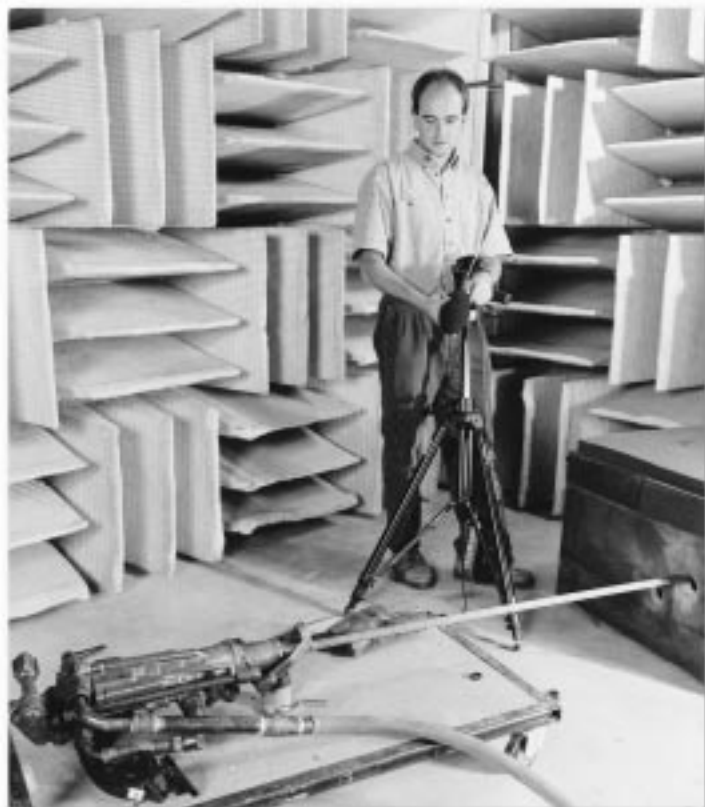
Rémy Oddo effectue des tests pour savoir de quelles composantes de la foreuse provient le bruit intense qu'elle émet.
