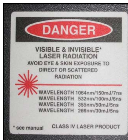
Figure 14 : Exemple de signalisation pour un laser de classe IV à la Faculté de génie
