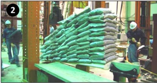
Essai destructif d'une aile d'avion
