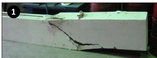
Essai destructif d'une poutre de béton
