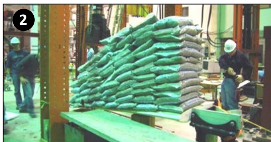
Essai destructif d'une aile d'avion
