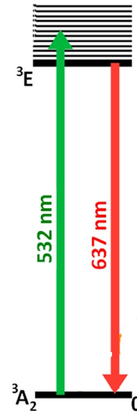
FIGURE 1. Diagramme de bande d'énergie. Dans le cas des centres NV l'énergie de stimulation est sous la forme lumineuse d'un laser vert 532nm et le gap à une énergie correspondant à la couleur rouge 637nm
