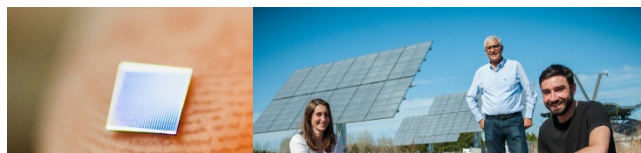
Photo de la cellule triple jonction de 0,089mm 2 , au bout d'un doigt, à côté d'une cellule millimétrique. Photo d'une partie de l'équipe de recherche devant le parc solaire de l'Université de Sherbrooke Photos : Université de Sherbrooke
