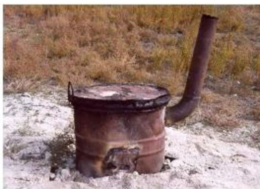
Figure 4.5 Incinérateur simple utilisé pour la combustion de déchets de soins dans un pays en développement (Tiré de Diaz et al. , 2005)
