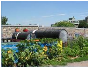
Figure 3.1: Composteurs rotatifs du parc Jeanne-Mance
